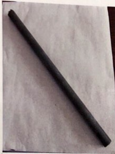
Fotografia 05: barra metálica de secção cilíndrica, oca.
