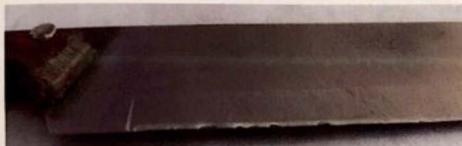
Fotografia 08: borda com pequenas fraturas.
