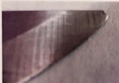
Fotografia 09: detalhe da ponta da faca fraturada.
